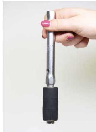
Sicherer Verbund von Packer und Steckschlüssel, geeignet für die Anwendung nach unten!
