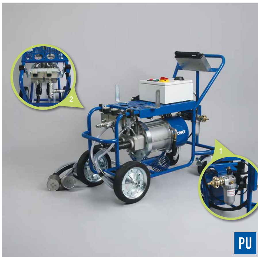
1. Réducteur de pression avec manomètre et dispositif anti-gel 2. Débitmètres
