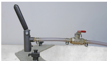
Glisser le DESOI Z-Slider sur le nipple à tête plate
