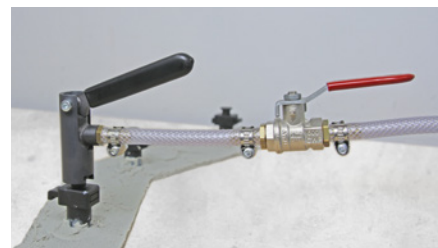
En actionnant le levier de serrage, le DESOI Z-Slider se met en place
