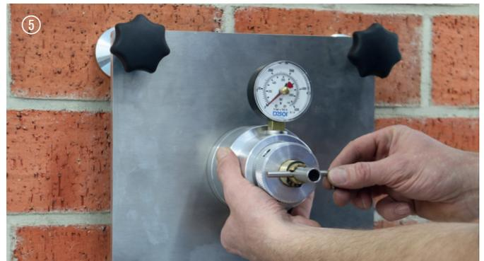
Ermittlung der Auszugswerte des DESOI Anker Plus W.
