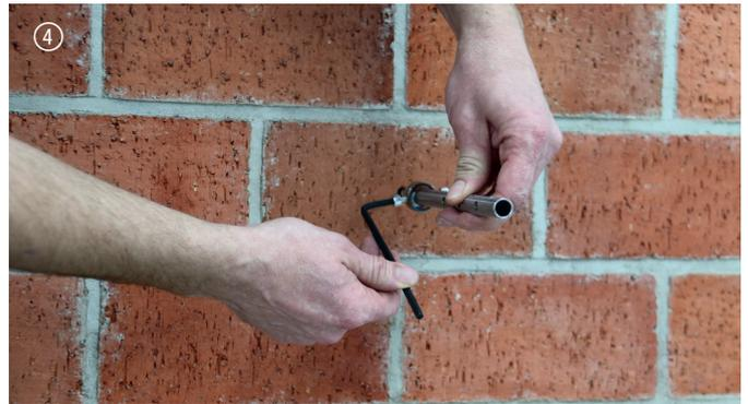
Auszugsprüfgerät durch Drehen der Rändelmutter in Position bringen.
