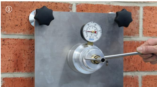
Auszugsprüfgerät auf Adapter stecken und an den Feststellschrauben horizontal ausrichten.
