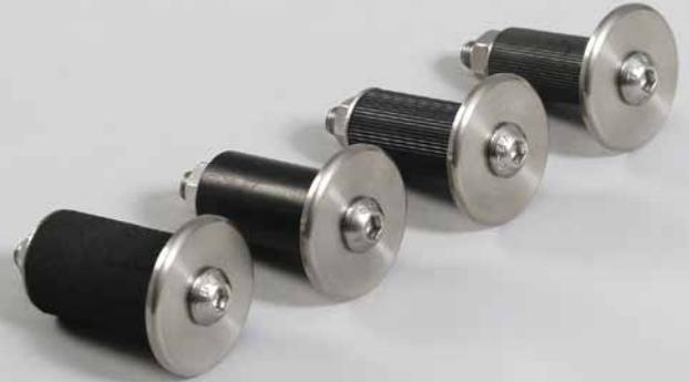
Der innovative Verschluss wertet jede Sichtbetonwand optisch auf. Das Verspannen der Packer in den Öffnungen erfolgt mit einem Sechskant über die Linsenkopfschraube – auch das Einbringen Über-Kopf in Decken funktioniert unkompliziert.
