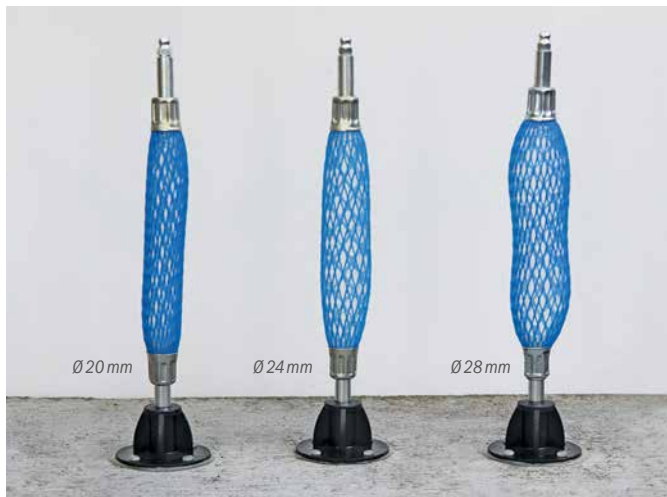
Druckvorratsschlauch mit Klebepacker gesetzt; (von links) Ø 20 mm: ca. 1,5 bar, Ø 24 mm: ca. 2 bar, Ø 28 mm: ca. 5 bar | Self-injecting hose with adhesive packer placed; (from the left) Ø 20 mm: 1.5 bar, Ø 24 mm: 2 bar, Ø 28 mm: 5 bar
